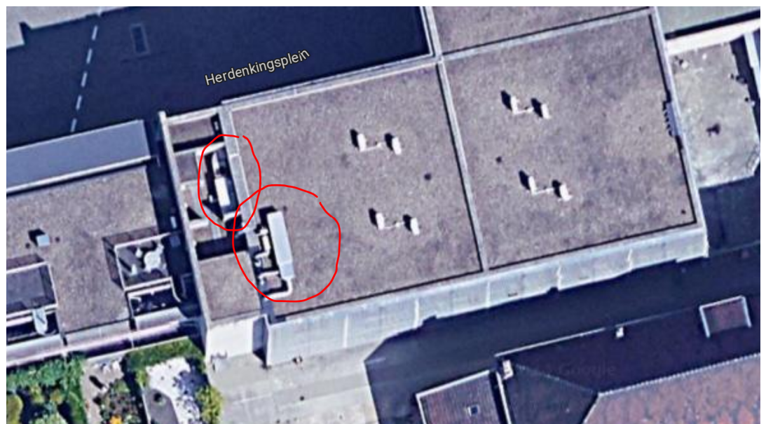
Figuur 3-2: Luchtbehandelingskasten bestaande situatie
